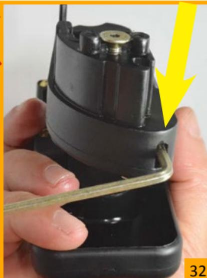
Tornillo de ajuste de la altura de la caja.
