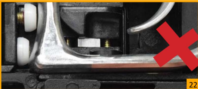
Anchura del seguro exagerada (muy ancha): el seguro no entra en el guarda monte, no deteniendo el arma en la funda.
