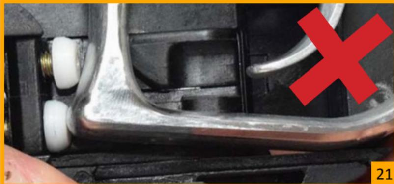
Anchura del seguro insuficiente (muy fina): el espacio entre el guarda monte y el seguro permite que el arma quede suelta.
