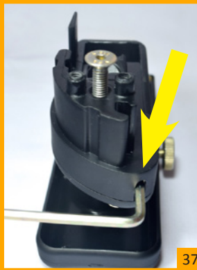
Parafuso de ajuste da altura da caixa.
